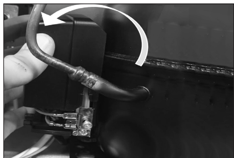
3. Tire de la tapa hacia atrás para aflojarla.
