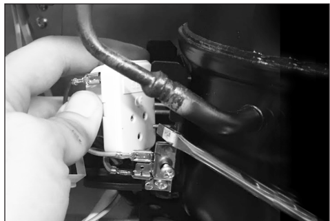
5. Dispositivo de arranque separado de la toma
