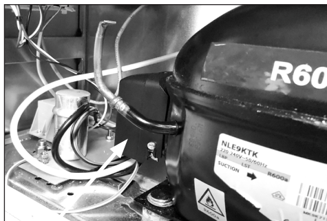
El dispositivo de arranque se monta en el lado izquierdo del compresor.
