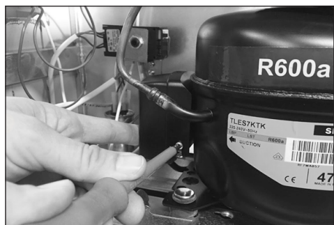
1. Desmonte la cubierta del dispositivo de arranque aflojando el tornillo Phillips.
