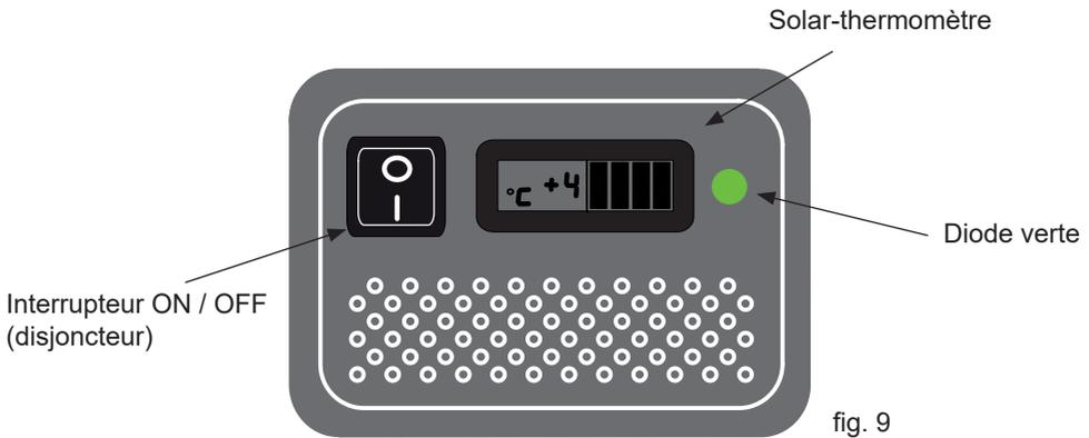
La diode verte indique que le compresseur fonctionne.
