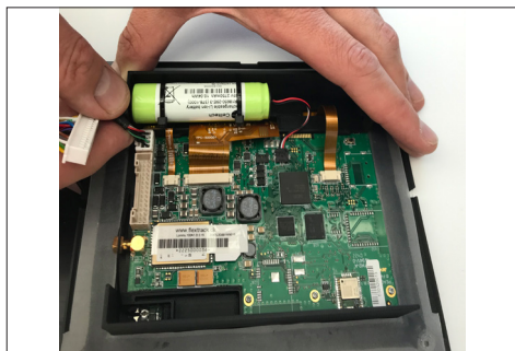
6. Replace the control-unit/display
