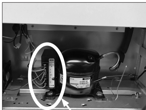
El dispositivo de arranque está montado a la izquierda del compresor.
