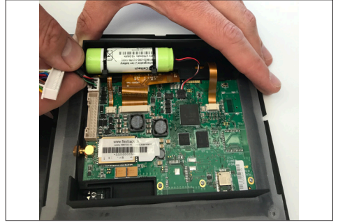
6. Replace the control-unit/display
