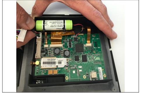
6. Replace the control-unit/display
