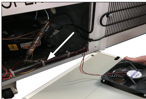
3. Loosen the wires
