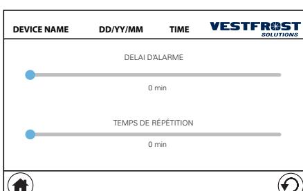
À cette page, il est possible d'accéder à la page de réglage du retard du signal d'alarme et du temps de répétition (temps de silence du signal acoustique lorsque, en présence d'une alarme, le bouton répéter est sélectionné) :
